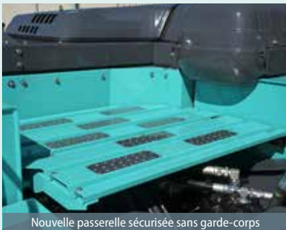
Nouvelle passerelle sécurisée sans garde-corps
