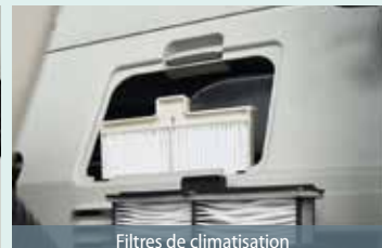
Filtres de climatisation
