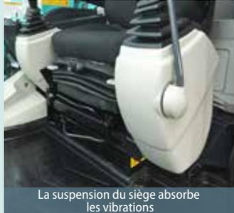
La suspension du siège absorbe les vibrations
