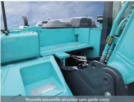
Nouvelle passerelle sécurisée sans garde-corps
